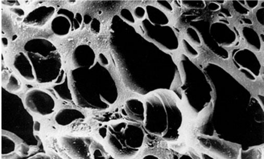
Figura 1. 4 – Imagem ilustrativa da porosidade de um carvão ativado;
